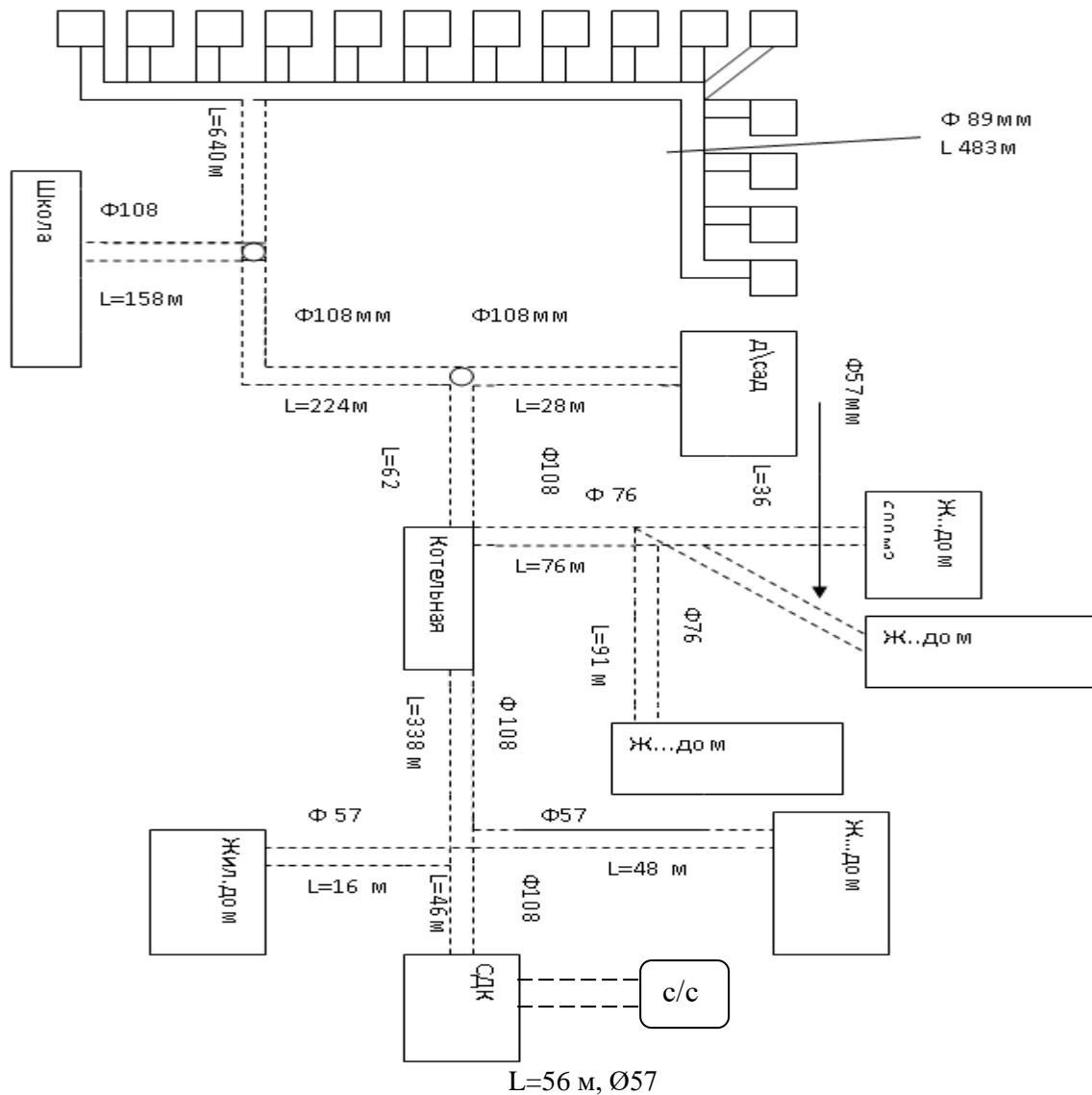
6. Централизованное теплоснабжение в п. Солнечный осуществляется ООО «Теплосеть+» для МКОУ «Солнечная СОШ» путем сжигания угольного топлива. Принципиальная схема мест расположения источника тепла представлена на рисунке 6:
